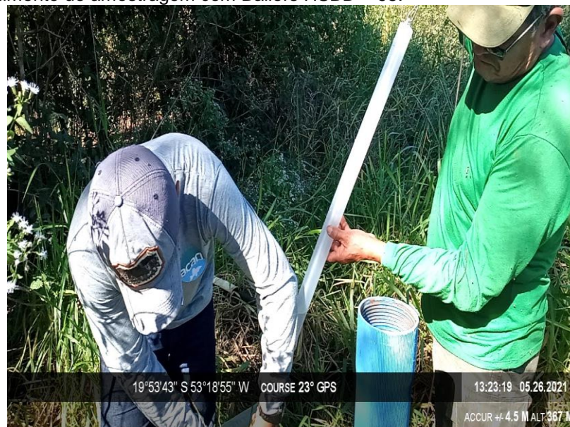
Figura 4 - Procedimento de amostragem com Bailers HSBD – 95.
