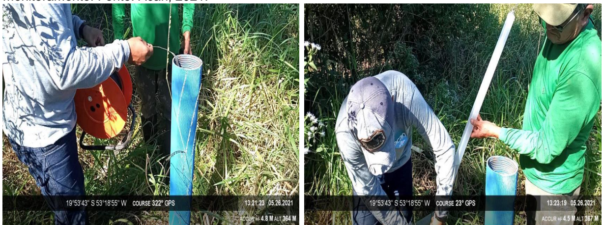
Figura 2 – Procedimentos de medição do nível d'água e de coleta de água dos poços de monitoramento. Fonte: Acari, 2021.
