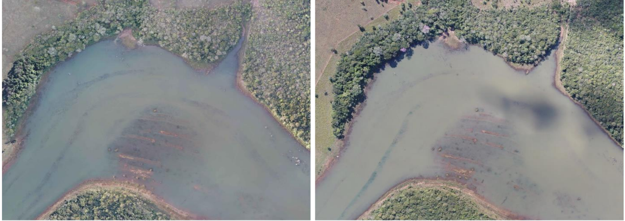
Figura 11 – Comparativo Aerofotogramétrico de assoreamento em um ponto do reservatório, entre junho/2020 e junho/2021. Fonte. Medeiros dos Santos, 2021.
